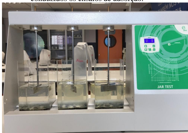
Figura 7 - Agitadores mecânicos da Ethik Technology modelo 217-1 onde foram conduzidos os ensaios de adsorção.
