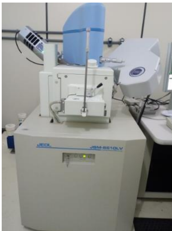
Figura 13. Microscópio eletrônico de Varredura marca JEOL modelo JSM 6610LV
