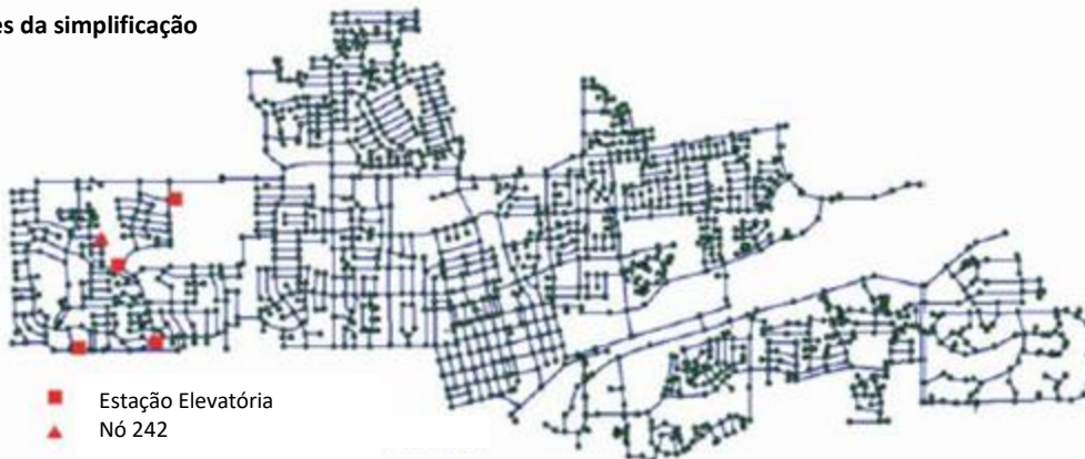
Figura 10 – Rede de distribuição antes e após simplificação
