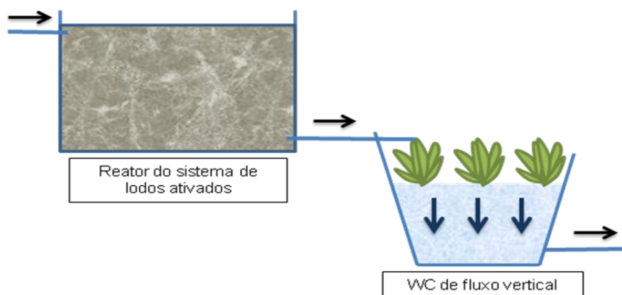
Figura 14 - Esquema de funcionamento do reator do lodo ativado seguido do WC de fluxo vertical
