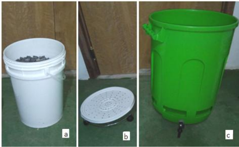
Figura 25 - Componentes do WC sem as plantas: wetland construído com brita nº1 (a); fundo falso (b), e recipiente externo com abertura na parte inferior (c)
